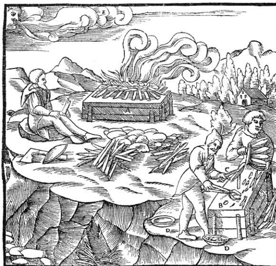
Fig. 1.12 - Arrostimento dei minerali di bismuto, dal De re metallica di Georgius Agricola. AGRICOLA 1556 e 1561, p. 352.
