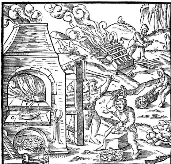
Fig. 1.11 - Arrostimento dei minerali di bismuto (nel forno vengono arrostiti i minerali senza Kobolt/Cadmia), dal De re metallica di Georgius Agricola. AGRICOLA 1556 e 1561, p. 351.
