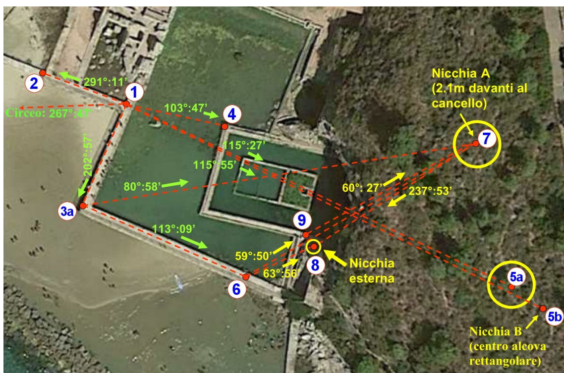
Figura 5. Valori di azimut rispetto al Nord delle direzioni che congiungono le varie postazioni. I valori relativi alle direzioni puntate dalle postazioni n. 1 e n. 3a (in verde) sono ottenuti tramite l'uso della bussola solare ed hanno una accuratezza di 1'. Gli altri (in giallo) hanno accuratezza di 2'. Le coppie di postazioni sui muri (1-3 e 3a-6) giacciono su rette parallele ai rispettivi muretti.
