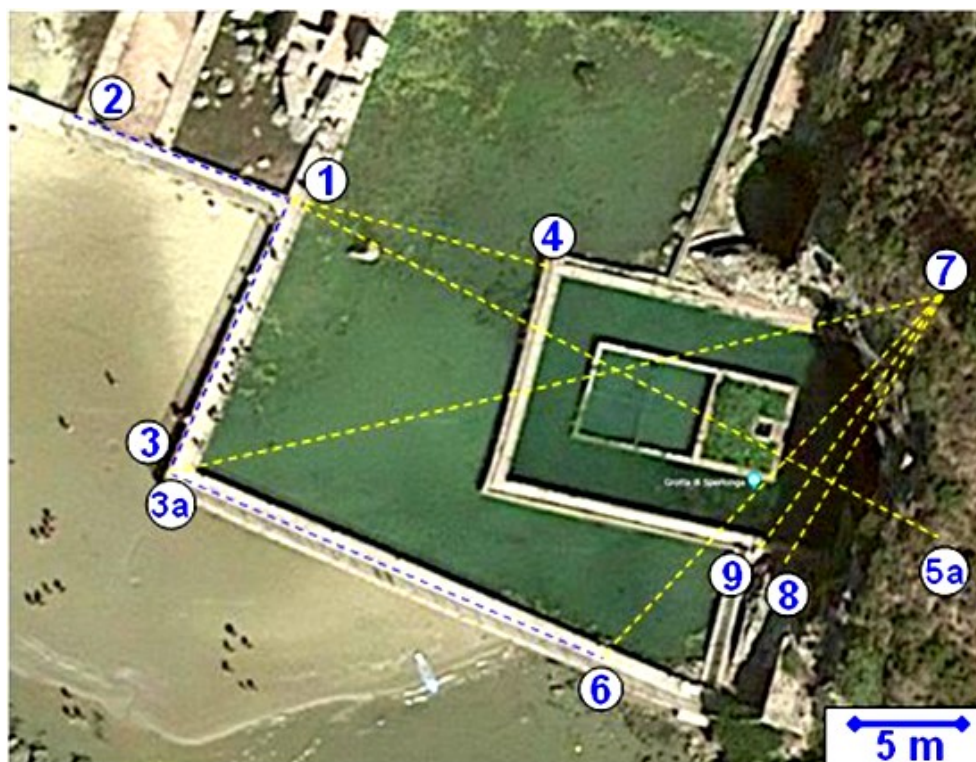
Figura 2. Foto del sito archeologico, tratta da Google Maps, e numerazione delle postazioni in cui si sono eseguiti rilievi con la bussola solare. Le linee tratteggiate mostrano le direzioni delle quali è stato misurato l'azimut. Le postazioni n.5a e n.7 sono interne alla grotta e qui riportate in pianta.
