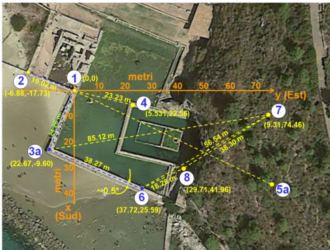
Figura 6. Ricostruzione su piano cartesiano della posizione delle varie postazioni con indicazione delle loro coordinate e distanze relative. È segnalato lo scostamento di 0,5^\circ dal parallelismo tra la direzione 3a \rightarrow 6 ed il muretto adiacente.
