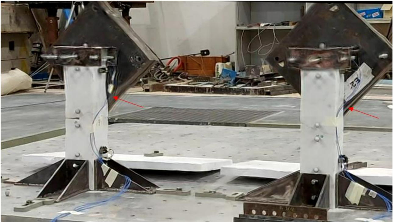
Figura 39. Amplificazione A = 20 , range 2 – 6 Hz. Anche con una ridotta magnificazione, si osservano diverse ampiezze di oscillazioni per i due pilastri.
