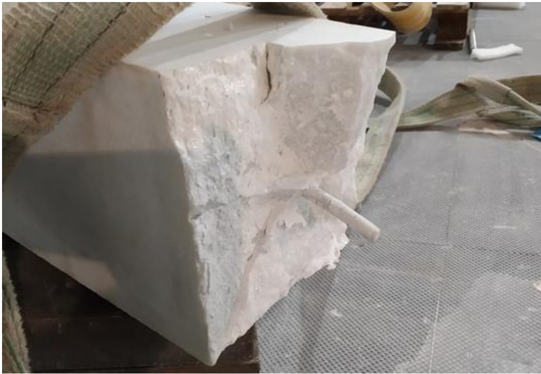
Figura 32. Dettaglio del frammento superiore del provino C1R realizzato con un solo perno dopo rottura finale nella PROVA 3.
