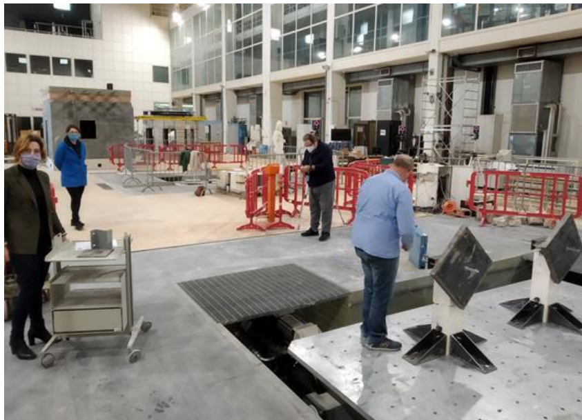
Figura 18. Area sperimentale predisposta presso i laboratori ENEA del C.R. Casaccia per le verifiche sperimentali su tavola vibrante con l'allestimento dei provini per le prove.
