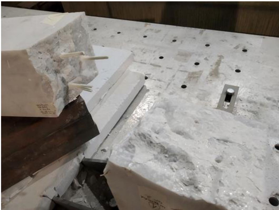
Figura 33. Rottura finale del provino C2R con 3 perni nella PROVA 3.
