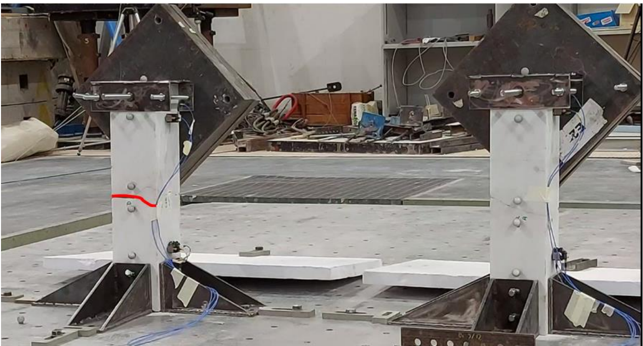
Figura 38. I pilastri all'inizio del test precedente la prova che ha prodotto il collasso: a sinistra il provino C1R, a destra il provino C2R. In rosso è evidenziata la frattura ricomposta.
