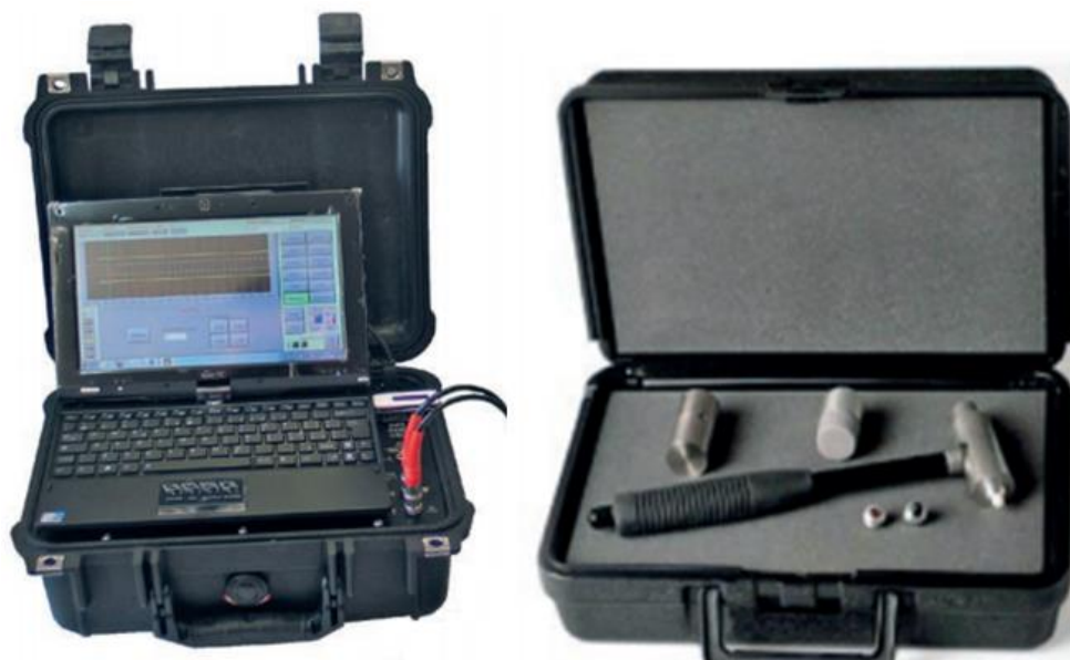
Figura 34. Strumentazione impiegata per le prove con martello sonico.
