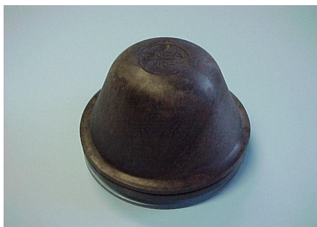
Figura 1 Dispositivo Passivo per la misurazione del radon dell'ENEA
