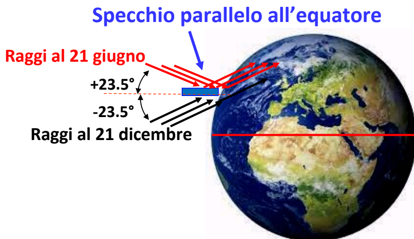
Figura 4. Principio di funzionamento del “Convertitore dei Solstizi”: lo specchio, orientato con la sua normale verso la stella polare e quindi parallelo all’equatore, riflette i raggi del sole di qualsiasi giorno a declinazione positiva (dal 21 marzo al 23 settembre) in modo tale che siano diretti come i raggi del giorno in cui il sole ha declinazione opposta; in particolare, i raggi del giorno del 21 giugno (declinazione +23.5^\circ ) sono convertiti nei raggi del 21 dicembre (declinazione -23.5^\circ ).
