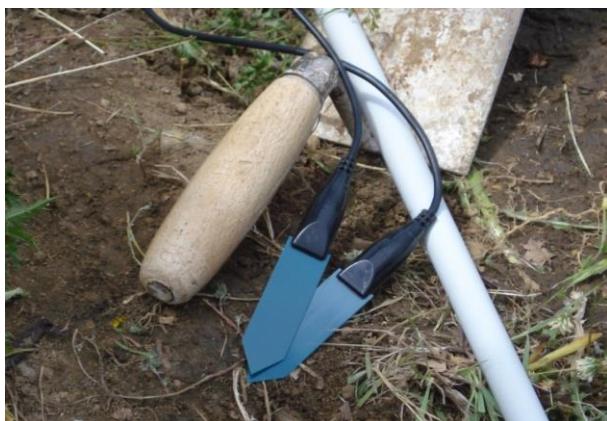
Figure 9 e 10 – Sonde FDR in fase di installazione (a sinistra) e pozzetto e data logger (a destra)
