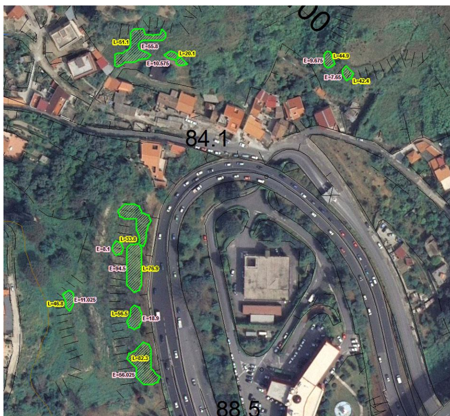
Figura 5 - Esempio di aree a suscettibilità molto elevata (retinato verde) con visualizzate le distanze di propagazione (giallo) espresse in metri e le energie cinetiche massime (rosa) espresse in migliaia di joule
