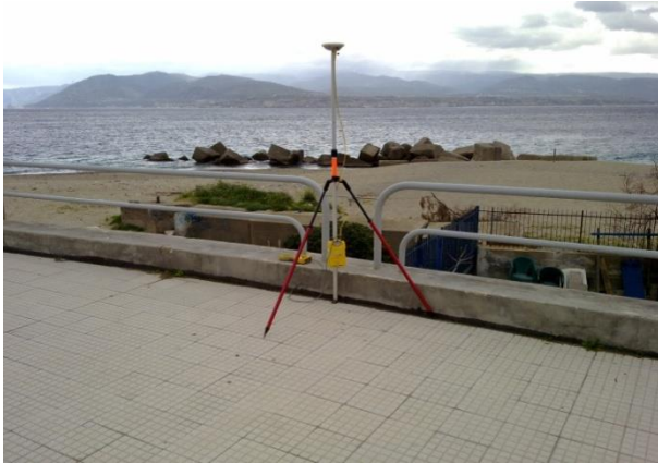
Figura 27 - Tra due ringhiere: punto materializzato a terra.
