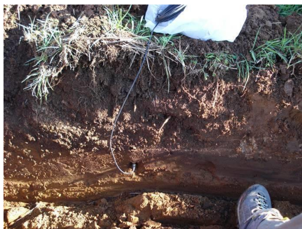
Figure 12 e 13 - Trincea realizzata nel sito della Casaccia (a sinistra) e sonda FDR sulla parete di scavo (a destra)
