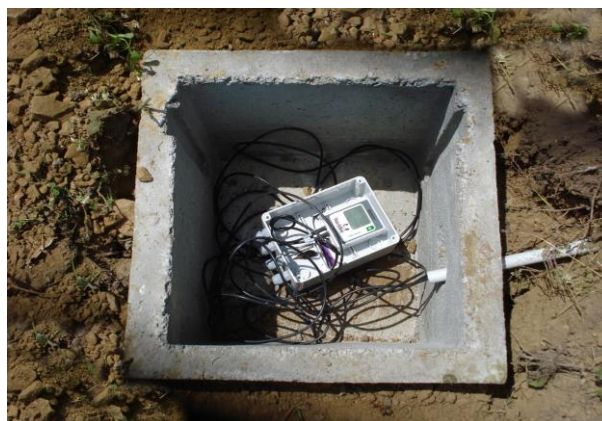
Figure 9 e 10 – Sonde FDR in fase di installazione (a sinistra) e pozzetto e data logger (a destra)
