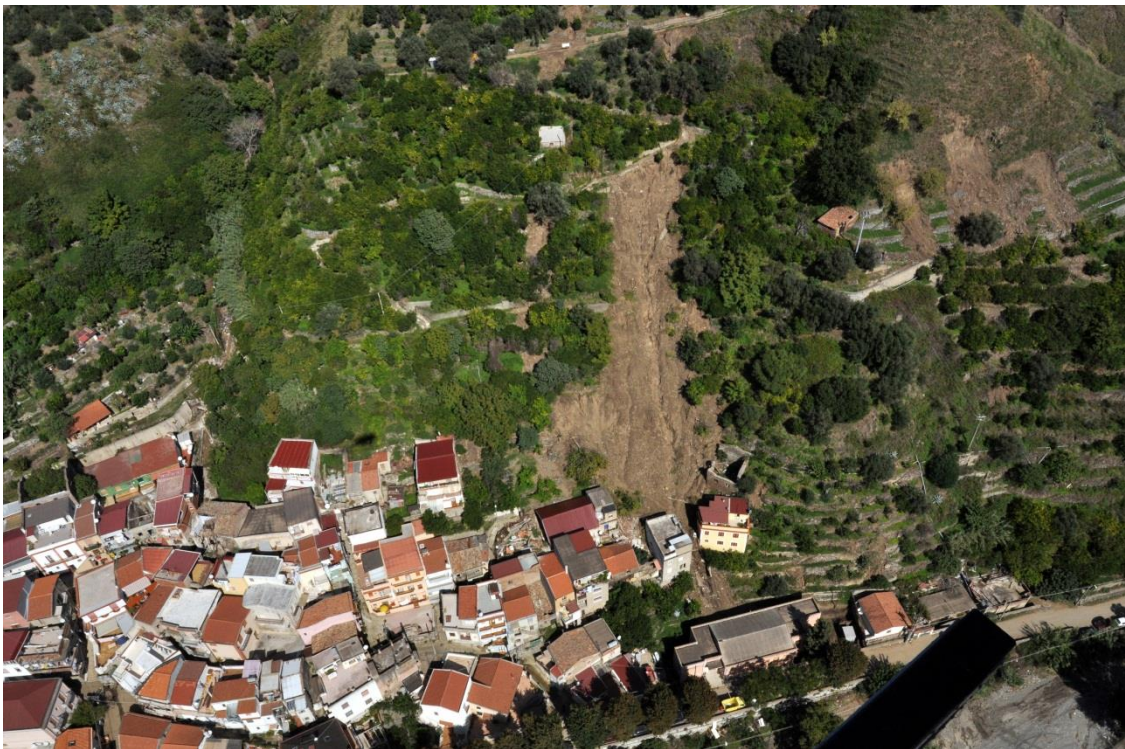
Figura 21 - Ruolo degli elementi antropici: fenomeno franoso strettamente legato alla presenza di un'interruzione antropica del versante che ha contribuito all'incremento della suscettibilità all'innescio di colate rapide
