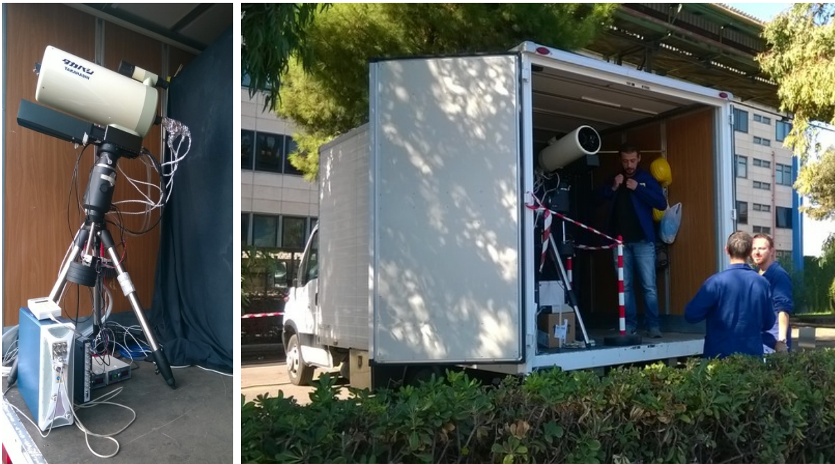
Figura 3. Il sistema lidar ELIASS ed il montaggio sul laboratorio mobile.
