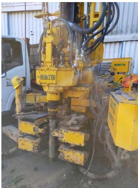
**Figura 3:** Avanzamento della testa rotante a fine corsa, coppia di ganasce per il blocco delle aste
