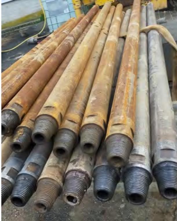
**Figura 4:** Aste di perforazione
