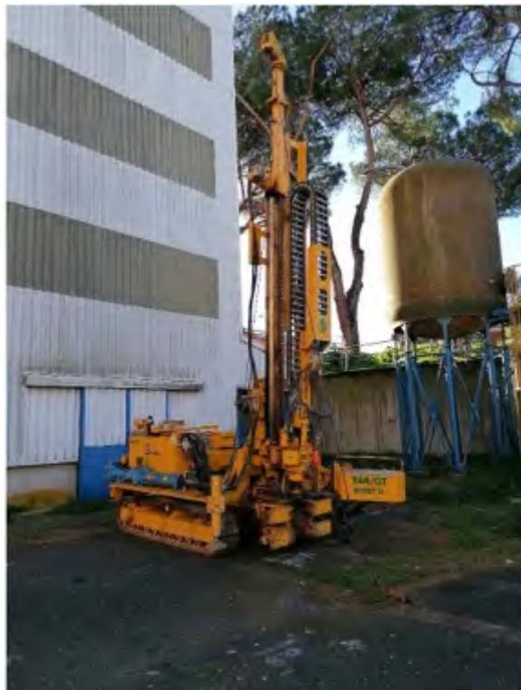
**Figura 2:** Perforatrice cingolata Beretta T44-GT
