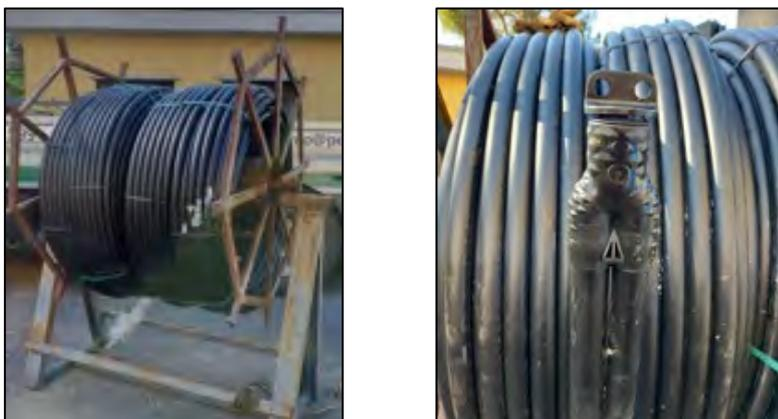
**Figura 9:** Sonde geotermiche in polietilene PN16. In evidenza, il piede della sonda (foto a destra)
