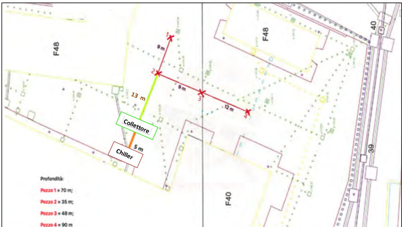
**Figura 32:** Ubicazione pozzi geotermici, collettore e chiller e relative distanze reciproche
