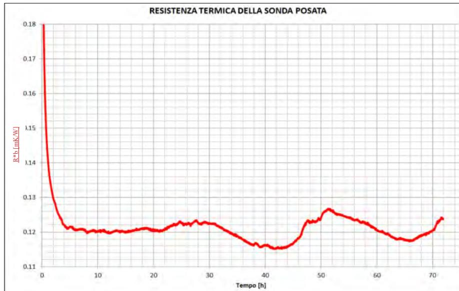
**Figura 26:** Andamento della resistenza termica della sonda nel pozzo 1
