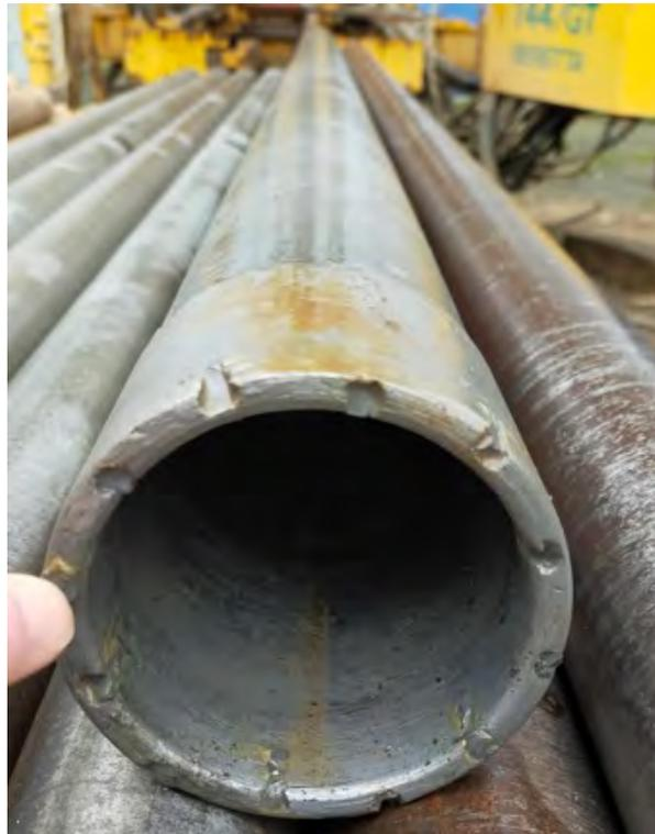
**Figura 5:** Carotiere per il recupero del materiale (carote)
