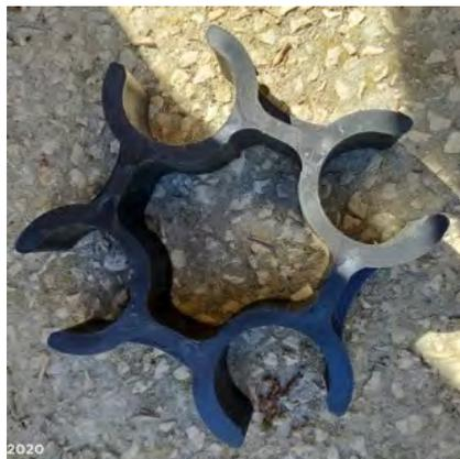
**Figura 11:** Distanziale. Le sedi in posizione esterna sono gli alloggiamenti delle sonde, il foro centrale è riservato al tubo getto
