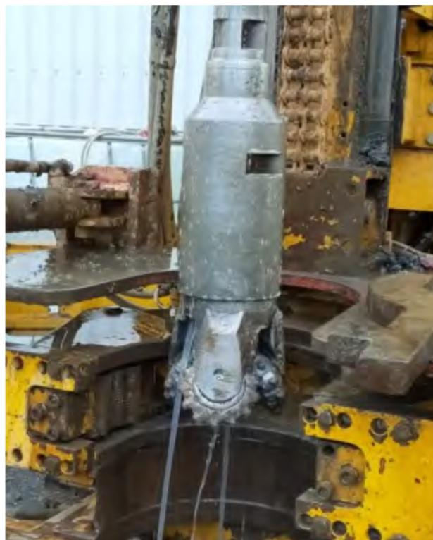
**Figura 7:** Tricono utilizzato per l'alesatura del foro fino al diametro di 148 mm
