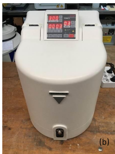
Figura 2. (a) Planetary ball miller Retsch monogiara con due contenitori in teflon per miscelazione slurry. (b) e (c) Planetary Mono Mill Fritsch (Pulverisette 6) con giara in zirconia da 250 ml, presenti nei laboratori ENEA SSPT-TIMAS-MCC di Faenza.
