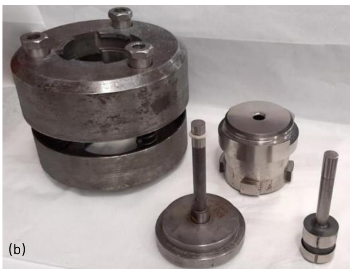
Figura 6. Pressa (a) Pressa uniaassiale in dotazione presso ENEA TEMAF; (b) Stampo in acciaio per forme cilindriche e accessori della pressa uniaassiale; (c) Pressa isostatica a freddo.
