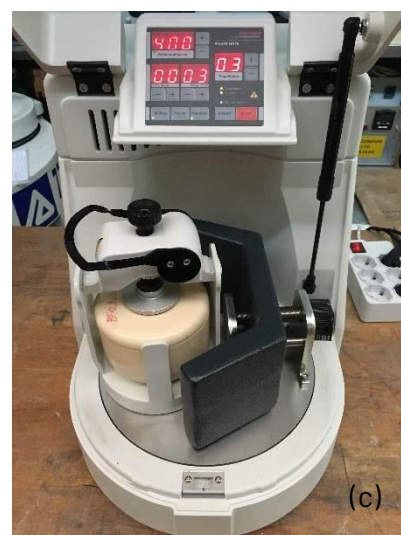
Figura 2. (a) Planetary ball miller Retsch monogiara con due contenitori in teflon per miscelazione slurry. (b) e (c) Planetary Mono Mill Fritsch (Pulverisette 6) con giara in zirconia da 250 ml, presenti nei laboratori ENEA SSPT-TIMAS-MCC di Faenza.
