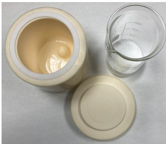
Figura 3. Giara in zirconia da 250 ml con singolo corpo macinante da 20 mm, contenente resina (in giara) e polvere di zirconia (TZ-3YS) in becher.
