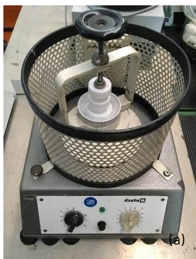
Figura 2. (a) Planetary ball miller Retsch monogiara con due contenitori in teflon per miscelazione slurry. (b) e (c) Planetary Mono Mill Fritsch (Pulverisette 6) con giara in zirconia da 250 ml, presenti nei laboratori ENEA SSPT-TIMAS-MCC di Faenza.
