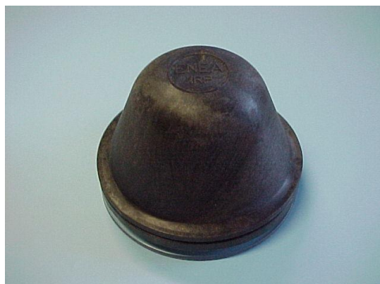
Figura 2 - Dispositivo Passivo per la misurazione del radon dell'ENEA
