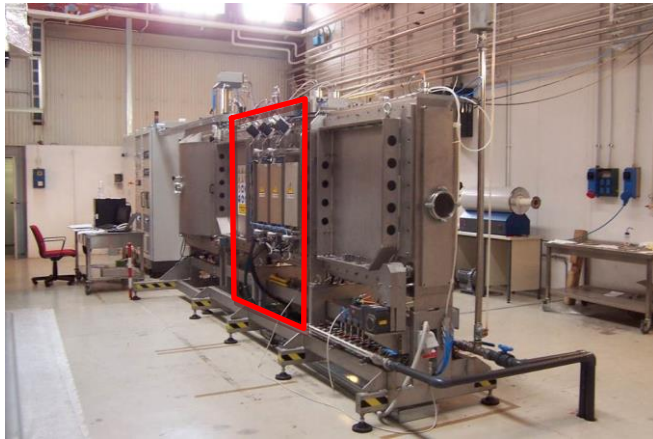
Figura 175. Vista dell'impianto di sputtering multi-catodo dell'ENEA con evidenziata la sezione di deposizione
