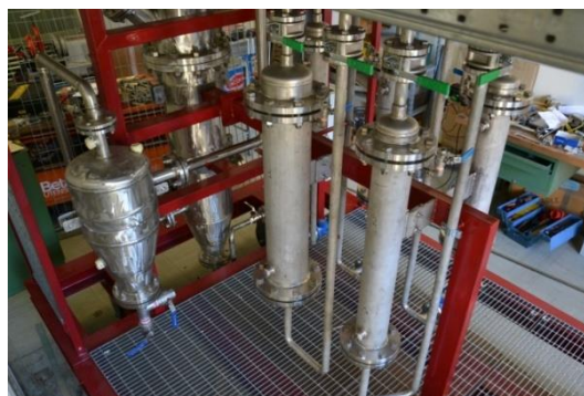
Figura 255. Impianto GESSICA: installazione e vista di insieme della nuova sezione di clean up
