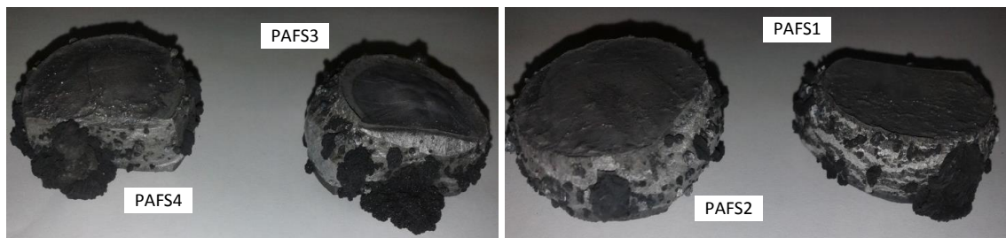
Figura 547. Campioni schiumati di precursori compositi con pelli di alluminio di spessore 1,5 +/-0,2 mm
