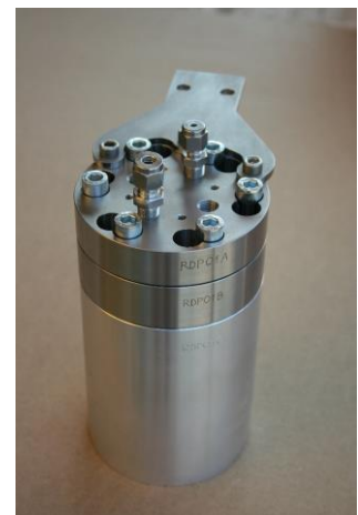
Figura 119. Reattore per la formazione dei gas idrati
