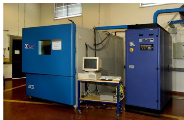
Figura 39. Camera climatica (sinistra) e ciclatore (destra)
