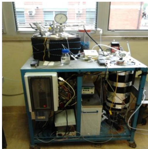
Figura 93. Impianto pilota di DA a doppio stadio
