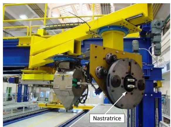
Figura 335. Nastratrice su braccio rotante
