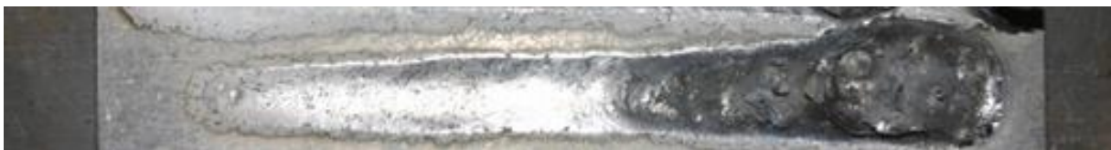
Figura 563. Effetti transitori dovuti alla bassa densità di energia del processo di saldatura TIG su AFS
