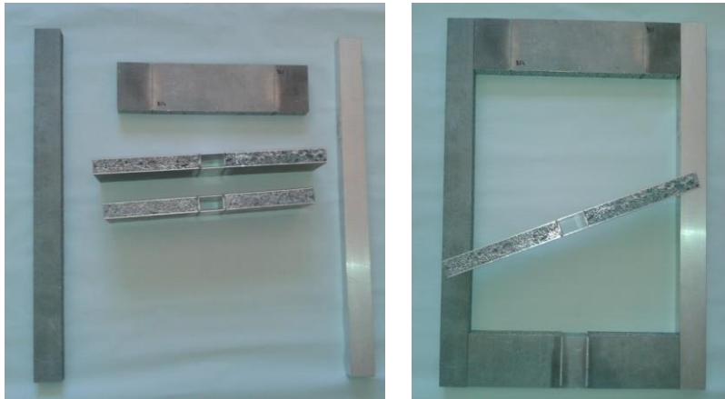
Figura 566. Simulacri di componenti alleggeriti ottenuti per assemblaggio di AFS e Profilati estrusi
