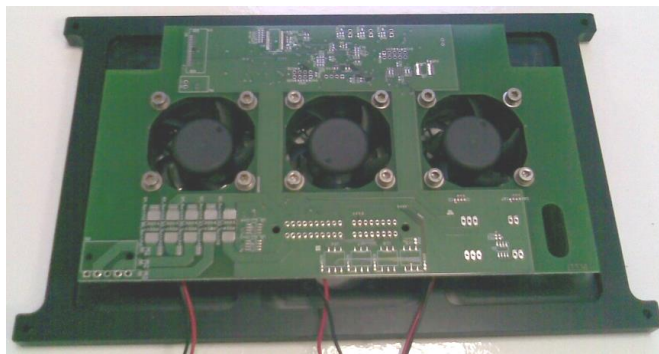
Figura 47. Nuova posizione della scheda elettronica BMS
