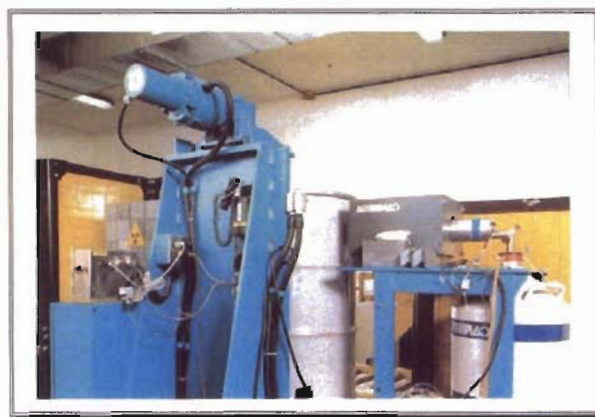
Fig. 4.16 – Impianto di caratterizzazione: catena di misura spettrometrica (fonte: NUCLECO)
