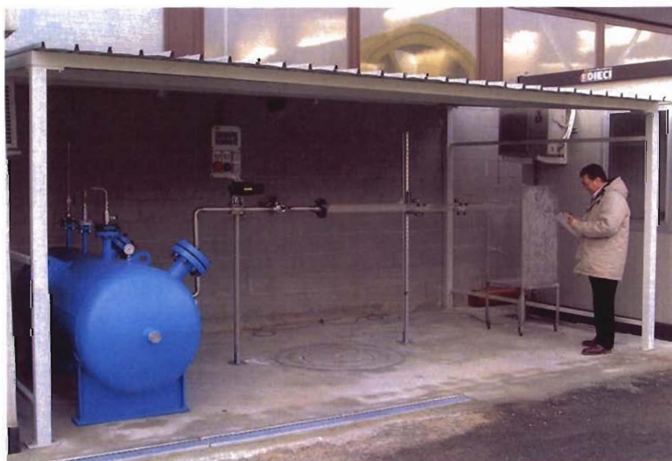
Fig. 4.12 – Impianto sperimentale SOFFIA, concepito per lo studio della risospensione delle polveri contaminate o infiammabili in situazione incidentali.
