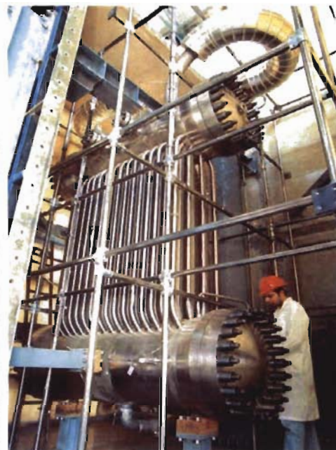
Fig. 4.6 – Prove in GEST su Isolation Condenser del reattore SBWR (fonte: Siet)
