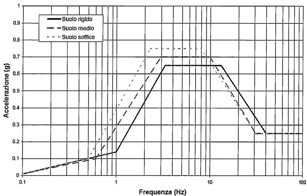
Figura 1.1 Spettro di risposta orizzontale al suolo
