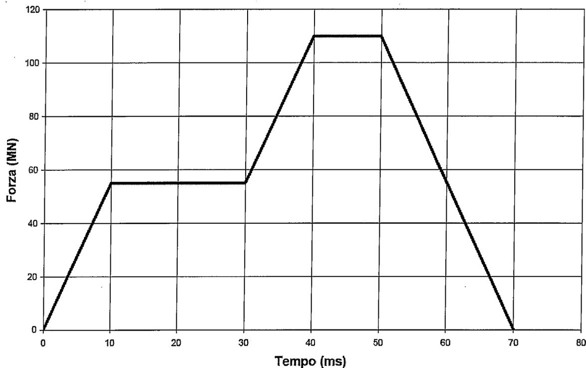
**Figura 1.3** Diagramma di carico associato ad impatto aereo
