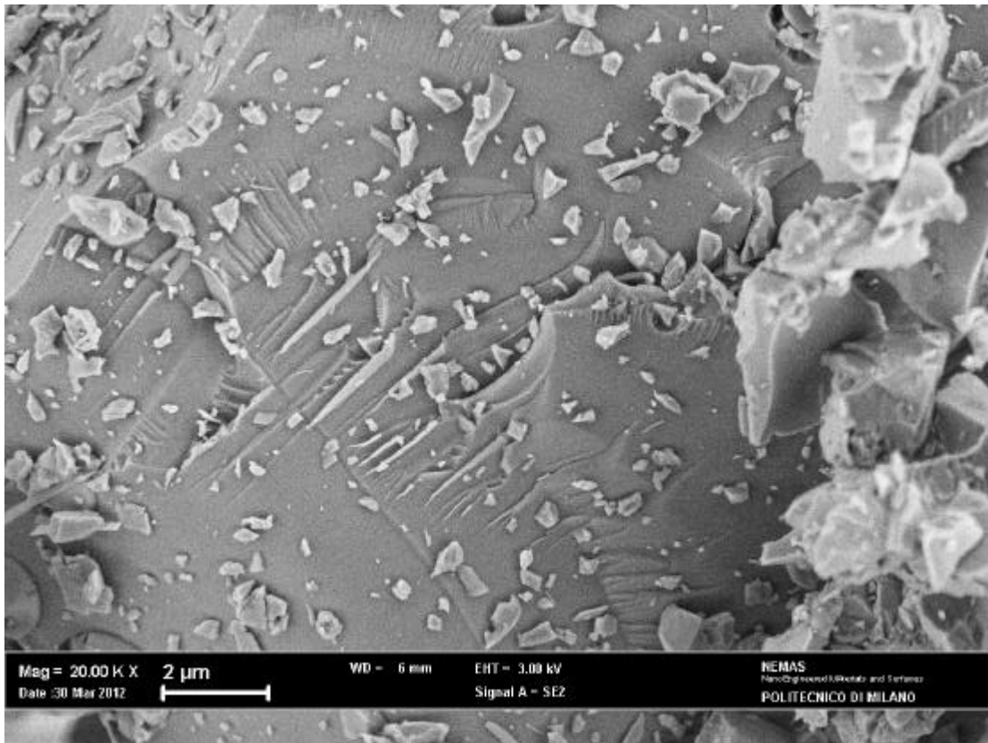
Figura 21. SOD.BG prima della lisciviazione. Ingrandimento 20000x
