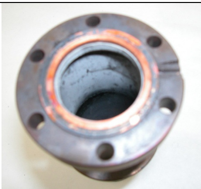
CsCl condensato all'interno del reattore
