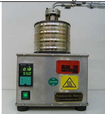
Fornetto verticale operante fino a 1200°C
