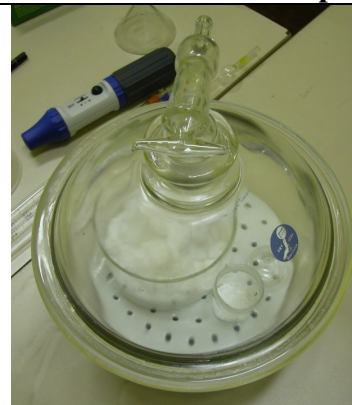
Conservazione del precipitato in essiccatore sotto vuoto
