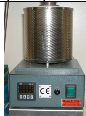
Fornetto verticale operante fino a 1100°C
