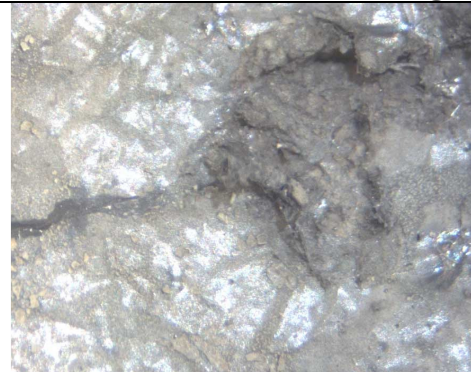
Superficie di Pb cristallizzato
