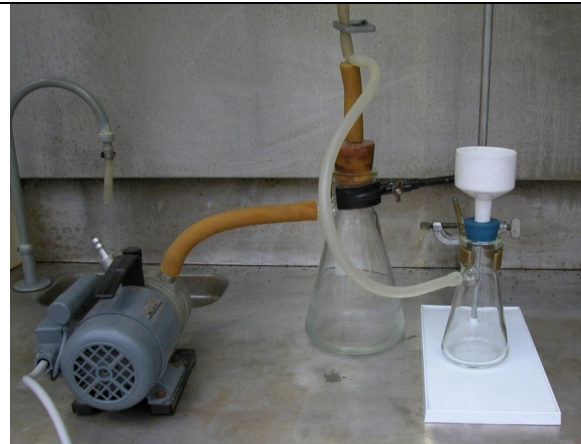
Filtrazione del precipitato sotto aspirazione
