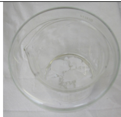
Precipitato sotto cloroformio per 24 ore
