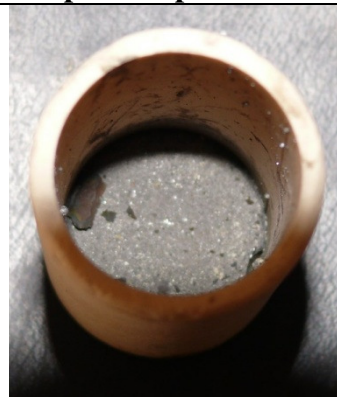
Crogiolo con il piombo al termine della prova
