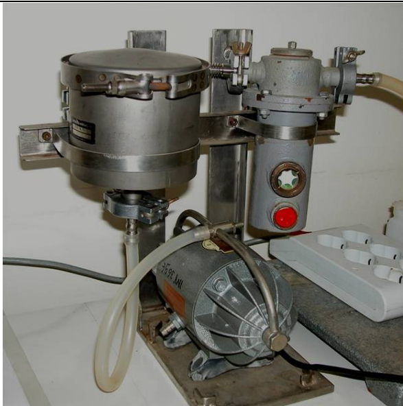
Pompa per insufflaggio d'aria con relativi filtri
