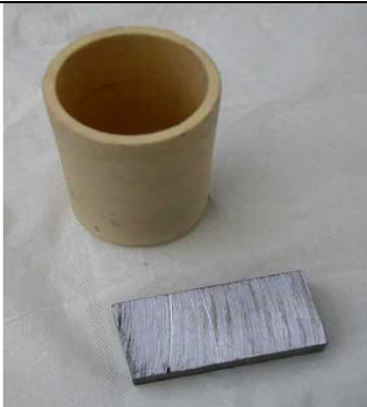
Panetto di Pb e crogiolino in allumina
