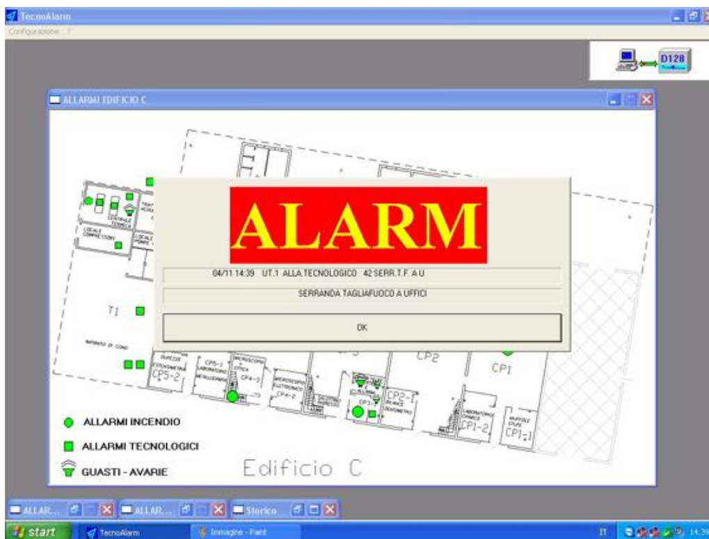
Figura n. 11.6 – Finestra avviso e descrizione allarme
