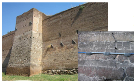
Figura 3. Le immagini mostrano una torre delle Mura Aureliane e un sensore installato su una delle sue fessure. Il grafico mostra la cronologia temporale dell'apertura di una fessura: la tendenza è guidata dalla temperatura ambiente media, con un ciclo sovrapposto di 24 ore dovuto alla variazione della temperatura notte/giorno
