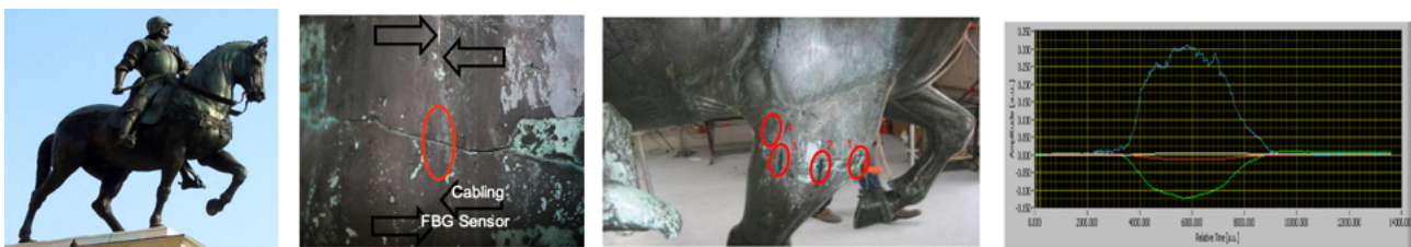
Figura 1. Da sinistra: il monumento equestre; un particolare della fibra quasi invisibile equipaggiata col sensore; i quattro sensori posti su una gamba; esempio di segnale acquisito che mostra una deformazione transitoria.
